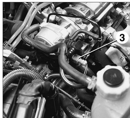
*Identification des sondes de température sur le boîtier thermostatique.*
