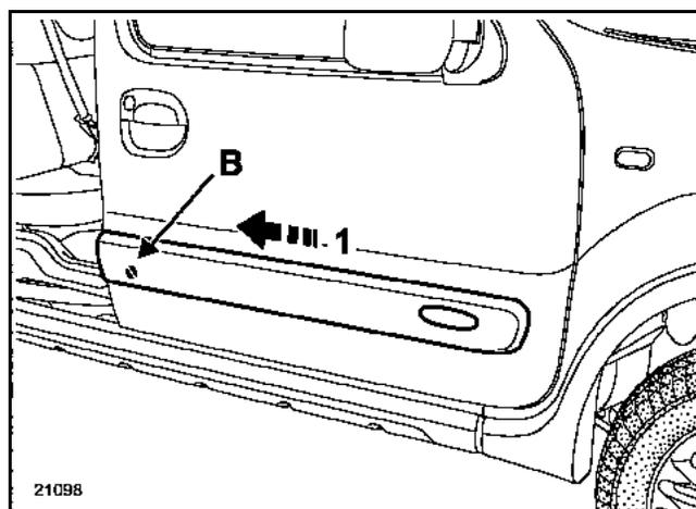
Dégager la baguette vers l'arrière du véhicule (1).
