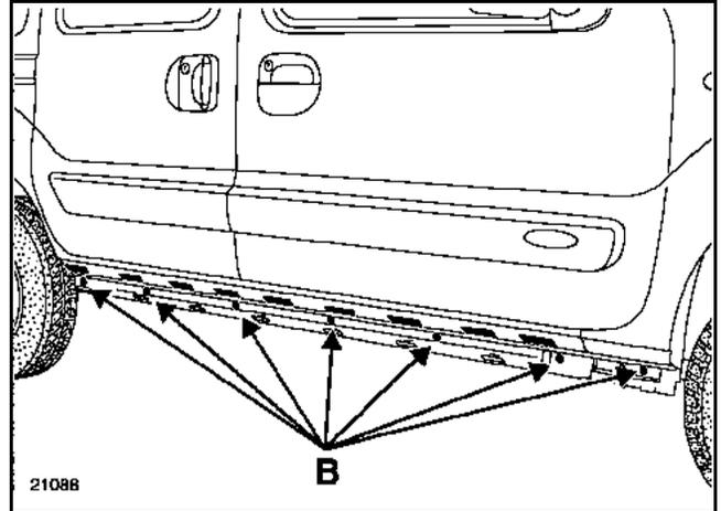
Déposer les écrous (B), puis dégager le support bas de caisse.
