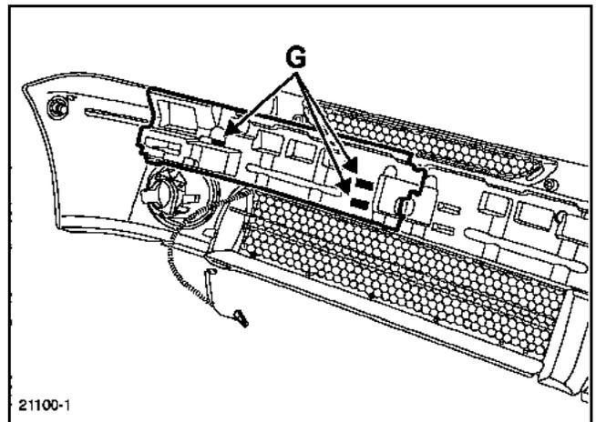
Dégager les clips (G), puis déposer l'absorbeur.
