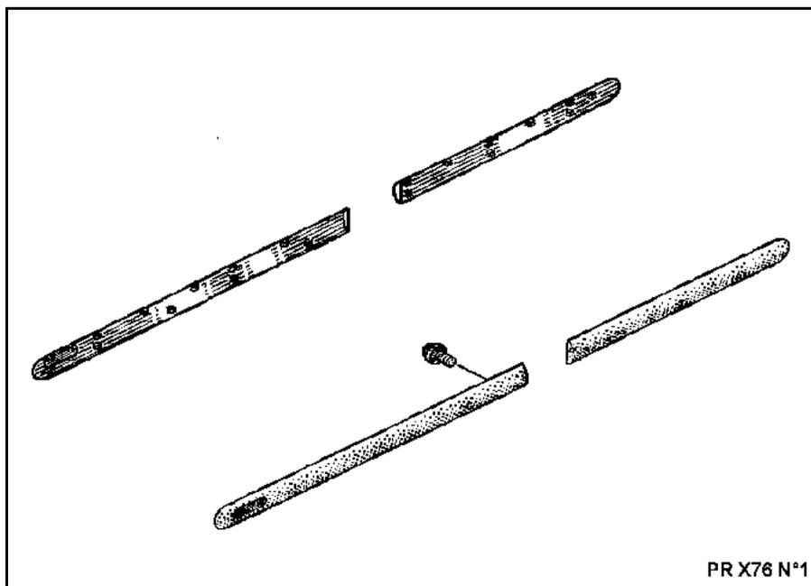
DEPOSE DE LA BAGUETTE DE PORTE AVANT
