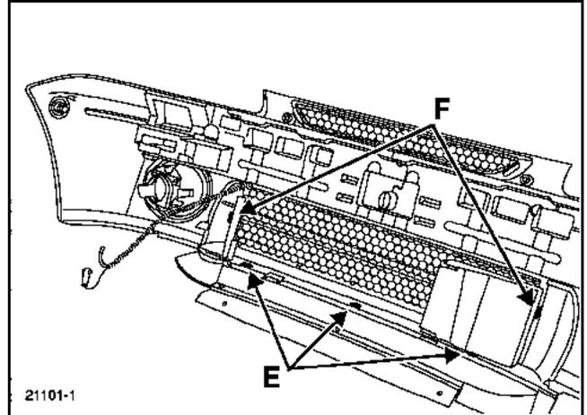
Déposer les rivets (E).
