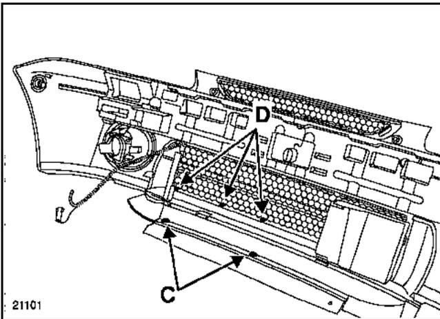
Déposer les rivets (C).
